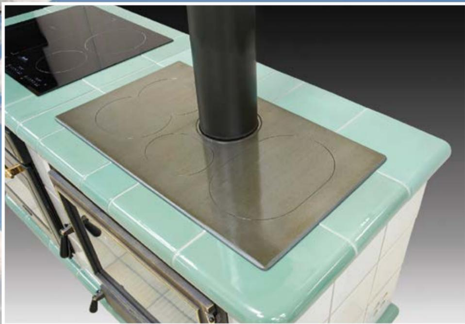
La cuisinière est équipée du foyer **ALP HASTAR**, hautement performant, avec un rendement de plus de **80 %**, un **CO** de **0.09 %** et un infime rejet de poussières de **29,5 mg/Nm<sup>3</sup>**. Il accepte des bûches de 55 cm et garde les braises pour un redémarrage même après **8 h de feu continu**.
